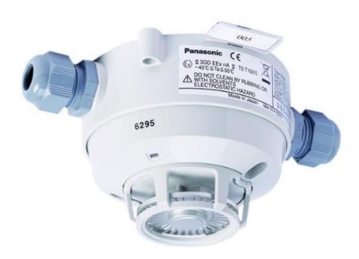
Des détecteurs thermiques sont utilisés dans des locaux où la température augmente rapidement en cas d'incendie et lorsque des détecteurs de fumée ne peuvent pas être utilisés. Ces détecteurs thermiques étanches sont montés à l'extérieur, comme à l'intérieur dans des pièces humides. Selon les versions, la température d'alarme varie de 57°C à 117°C, toutes conformes à EN54-5: 2000.
