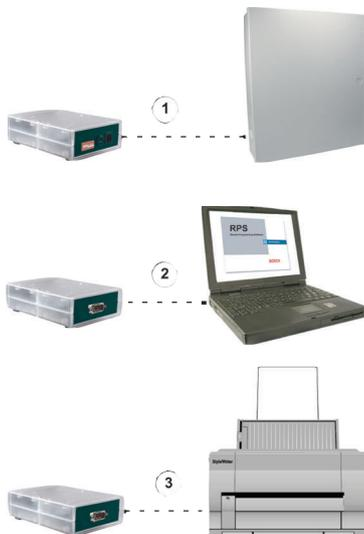
Le module interface série DX4010V2 se connecte à :
